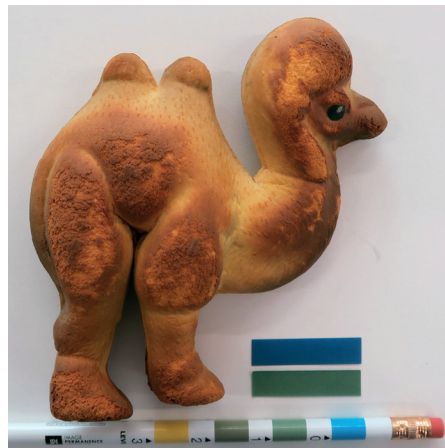
Vananenud kummiese eritab jõudsalt happelisi vääviühendeid. Selle tunnistajaks on happelistele ühenditele reageeriva indikaatorriba värvimuutus.
