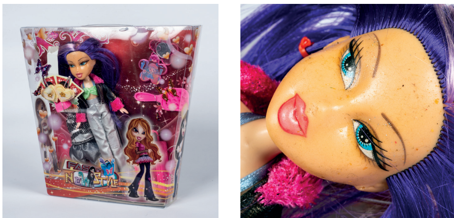
Originaalpakendis ja mitte kordagi mängumaailmas elanud nukk on märkamatult keemiliselt vananenud. Pehmendatud PVC-st valmistatud pea on pehmenusainete migratsiooni tulemusena kleepuvaks muutunud.
