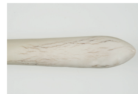
Melamiinformaldehüüdvaigust valmistatud noasaba on pideva veega kokkupuute tõttu kahjustunud.
