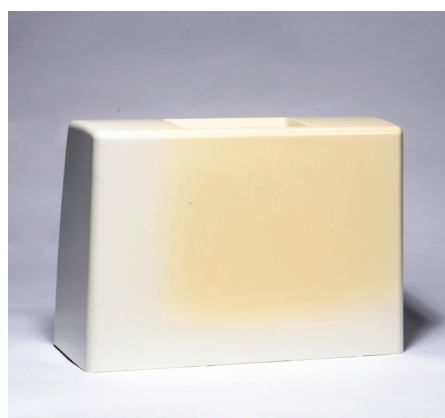
Õmblusmasina kaitsekaane pinnal on selgesti näha, missugused osad on pikemat aega otsese päikesevalguse käes olnud (polüstüreen).
