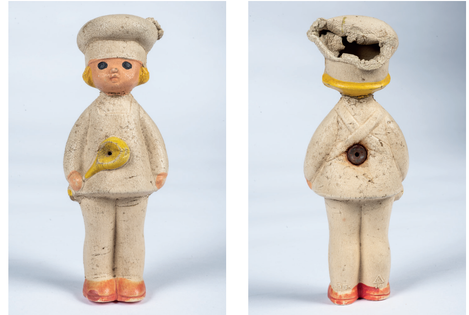
Pealtnäha heas seisus plastese võib olla tugevalt kahjustunud. Fotol kujutatud kummist mänguasi on oksüdeerunud ja selle tulemusena deformeerunud.
